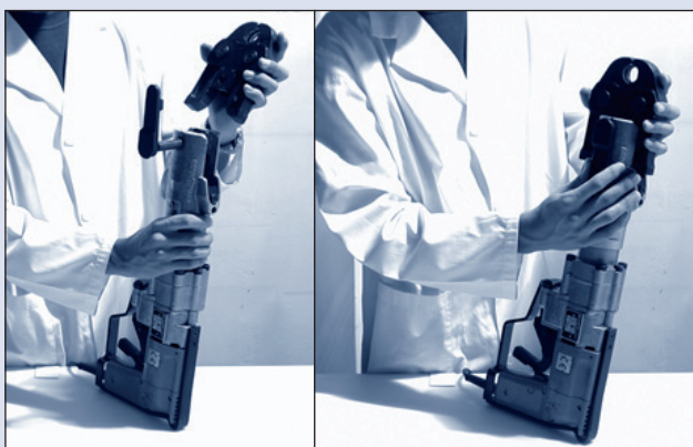
Fig. 27 Montering af presseudstyr Pressing tool assembly
