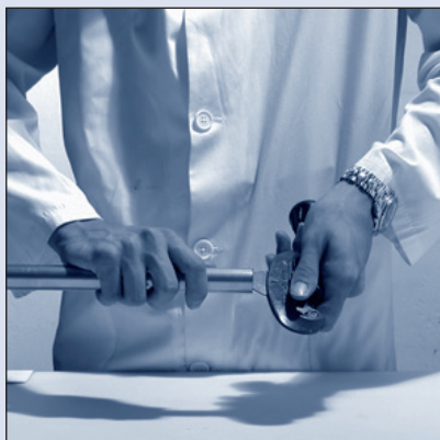
Fig. 22 Afgratning af rørender Pipe-end deburring
